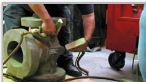
**Prueba de Partículas Magnéticas.**- WALWORTH<sup>®</sup> cuenta con el equipo para pruebas por partículas magnéticas aplicada a materiales ferrosos susceptibles a magnetismo. Esta prueba se realiza por muestreo o cuando el cliente solicita la Certificación de Partículas Magnéticas.
