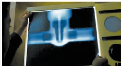
**Equipo para Examinación Radiográfica.**- WALWORTH<sup>®</sup> cuenta en sus instalaciones con su propia fuente de Iridio Ir-92, para pruebas de radiografía a las fundiciones desde 0.100" hasta 2 1/2" de espesor de pared, verificando la sanidad de las materias primas.
